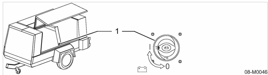
Fig. 42 «Battery isolating switch»
